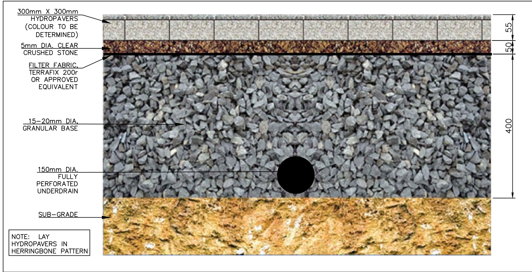
11 HYDROPAYER SECTION L203 SCALE: N/T.S.
